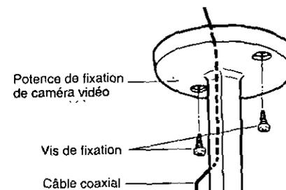
**Remarque:** Le câble coaxial peut être engagé par l'ouverture centrale de la potence de fixation de caméra vidéo de surveillance.
